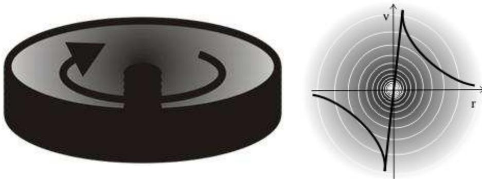
Рисунок 1.19. Изменение линейной скорости в вихре
